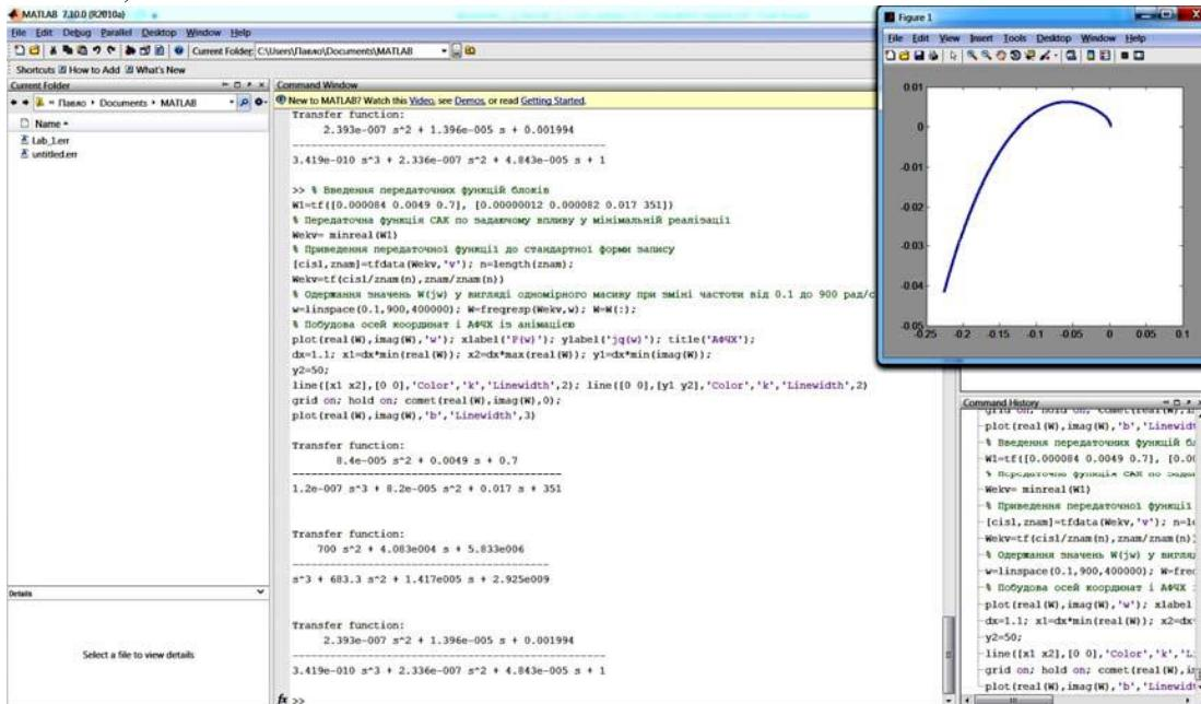
Рис. 10. АФЧХ САР, отримана після виконання файлу-схемарію
