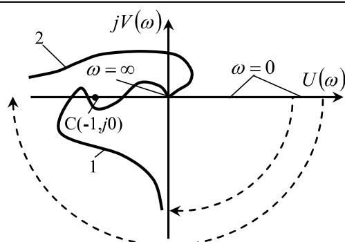
Рис. 3. АФХ стійкої (1) та нестійкої (2) замкнтих систем у розімкнутому стані при одному (1) та двох (2) нульових коренях характеристичного рівняння розімкнутого стану
