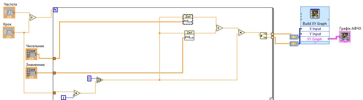
Рис. 8. Блок-схема програми для обрахунку стійкості САР
