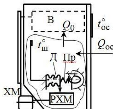
Рис. 4. Конструктивна схема САК температурою в шафі холодильника
